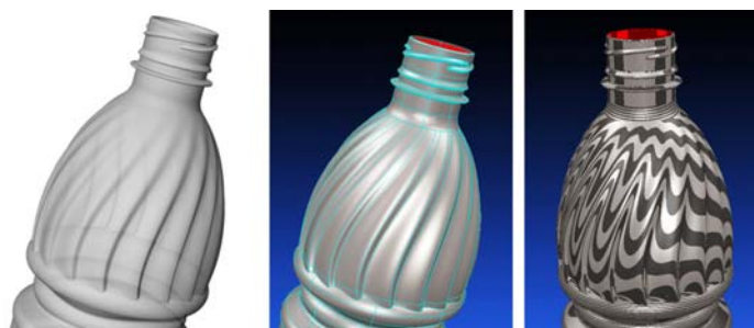
Figura 10. Discontinuidades perceptuales en una botella geoméricamente continua, como se ve en el análisis cebra. Superficie G2.
