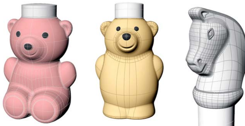
Figura 8. Diferentes envases con forma de animales, dónde las expresiones fueron logradas por mínimos movimientos de puntos en el espacio que transformaron las mallas.
