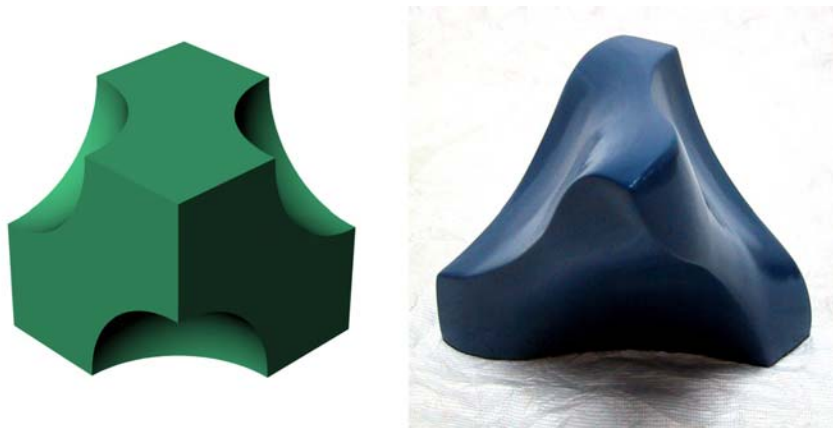
Figura 6. Diseño de un alumno que parte de la substracción de cuatro esferas de un cubo. Los redondeos selectivos rompen la simetría original y vinculan algunas caras adyacentes. Aunque se aumenta la continuidad se mantienen algunos bordes que enfatizan la tensión entre lo redondeado y lo discontinuo.
